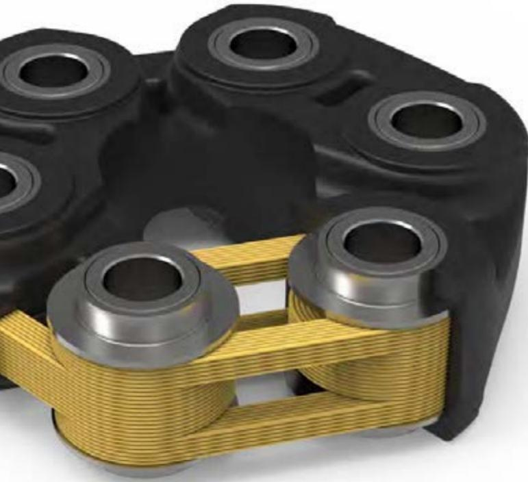
Das SGF-Zugkraftprinzip sorgt dafür, dass Drehmomente fast ausschließlich durch die ein-vulkanisierten Fadenpakete als Zugkraft übertragen werden.
