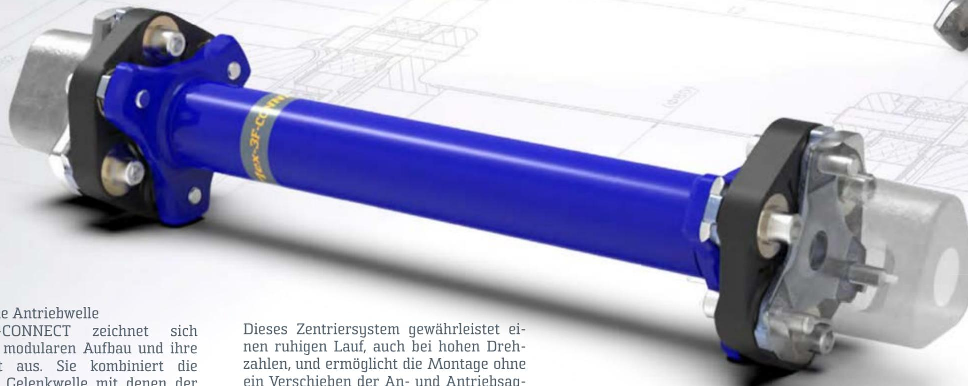
Die elastische Antriebswelle SGFlex-3FD-CONNECT zeichnet sich durch ihren modularen Aufbau und ihre Vielseitigkeit aus. Sie kombiniert die Vorteile der Gelenkwelle mit denen der Gelenkscheibe und bietet somit eine vibrationsdämpfende Alternative zu Gelenkwellen mit Kreuzgelenk.
